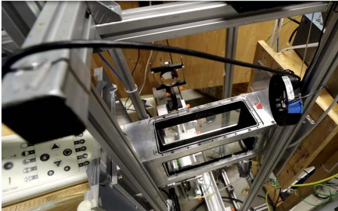
**Abb. 2 Tests im Windkanal bei AIRBUS zeigten, dass das Eis nach einer definierten Zeit von alleine von der strukturierten Oberfläche abfällt.**
